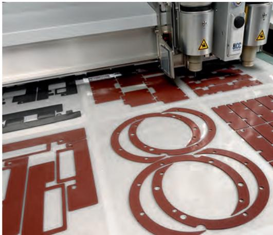
Ganz ohne Werkzeugkosten können CAD-Daten als DXF-Datei direkt in fertige und toleranzgenaue Schnittvorlagen umgesetzt werden. Die herausragende Produktionsgeschwindigkeit und eine bis ins Detail perfektionierte Schneidtechnik sorgen für ein optimales Ergebnis.
